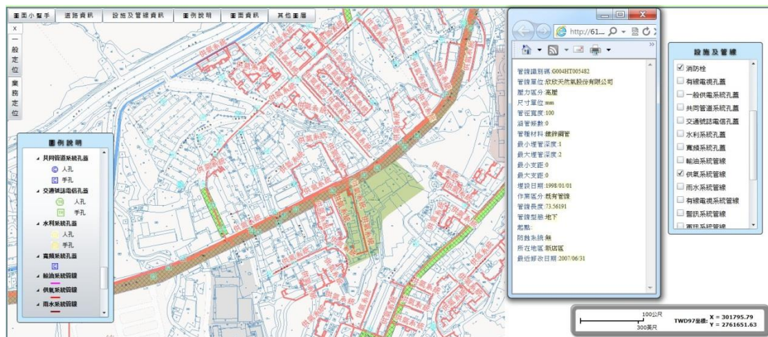
圖125 新北市供氣系統管線分布圖
