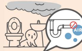
2. 排水孔下方設有「存水彎」；利用彎曲造型將積水留在排水管內，發揮隔氣作用，避免排水管內的臭味流入室內，所以也不會有新鮮空氣流入浴廁內。
