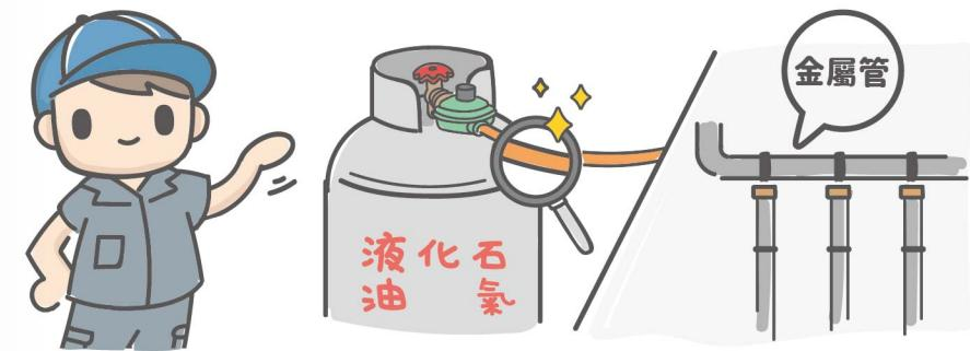
瓦斯軟管應保持清潔，不可凹折或遭擠壓，穿牆部分應採用金屬配管，接頭應以安全夾夾緊，如有老化龜裂或破損，應立即更新。
